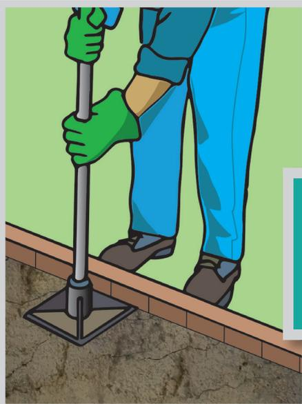
Se a calçada estiver sendo refeita, provavelmente o solo já terá sido compactado. Se a calçada for nova, deve-se primeiro compactar o solo com um sapo mecânico, placa compactadora ou socador manual.
