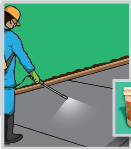
Após o acabamento, deve-se pulverizar um agente de cura química por sobre toda a superfície ainda úmida. Isso reterá a água do concreto por mais tempo e reduzirá a retração e as fissuras superficiais.
